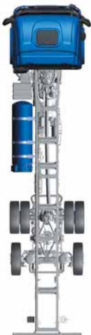
Serbatoio LNG sul lato sinistro, disponibile in combinazione con serbatoio LNG sul lato destro.
