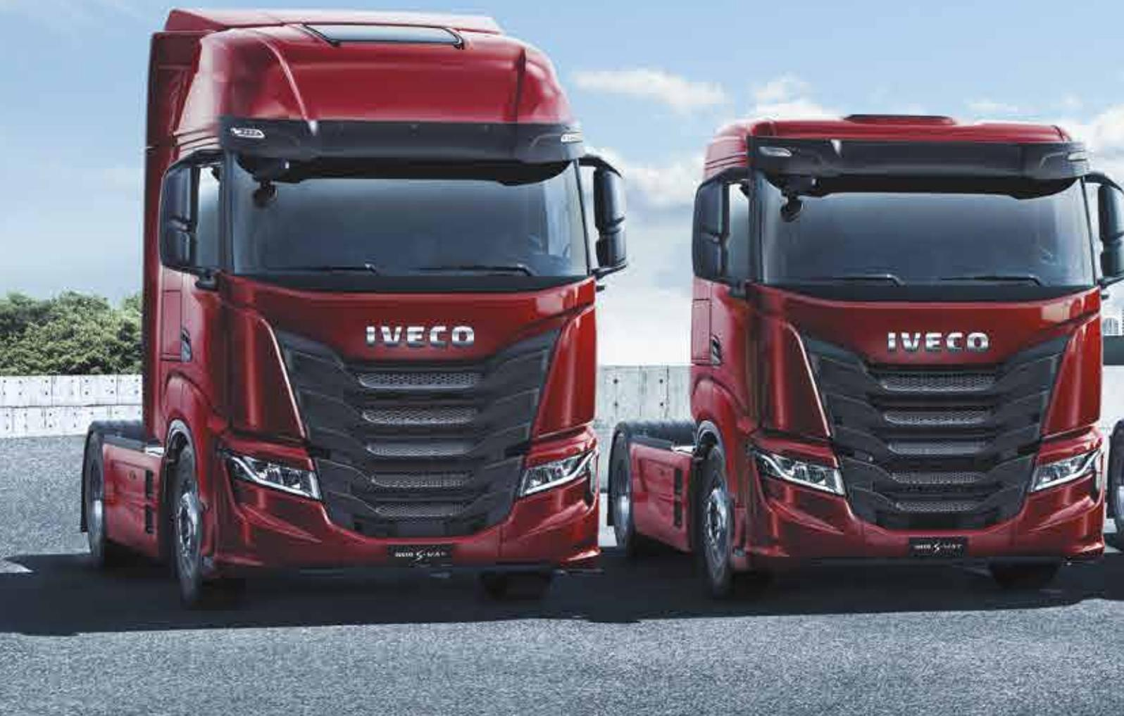
L'offerta di cabine dell'IVECO S-WAY include un'ampia selezione in grado di adattarsi a missioni specifiche: la cabina lunga **AS** con tetto alto o basso, la cabina media **AT** con tetto alto o basso e la cabina corta **AD** con tetto basso.
